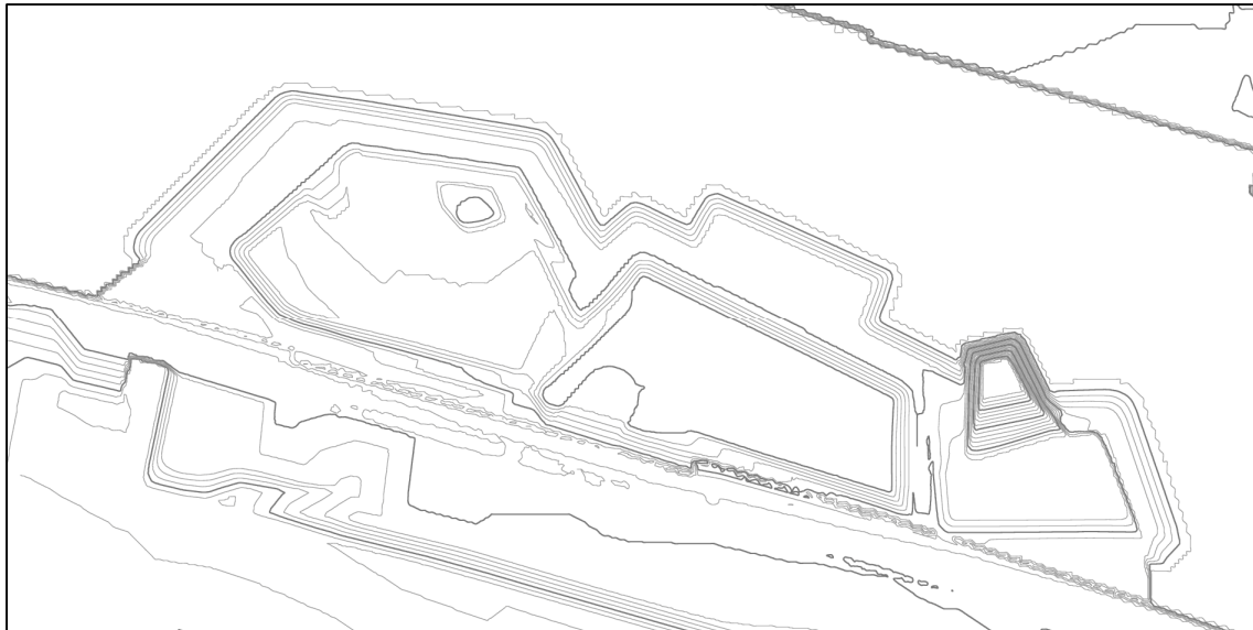
Abb.1: Geländemodell in der klassischen Darstellung für 2D-Pläne Darstellung mittels Höhenlinien (dunkelgrau 2,5 m und hellgrau 50 cm)
