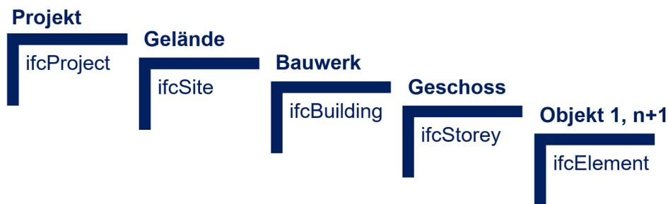
Abb. 13: Struktur eines Fach-/Teilmodells (IFC 2x3) (©BIM.Hamburg, 2021)
