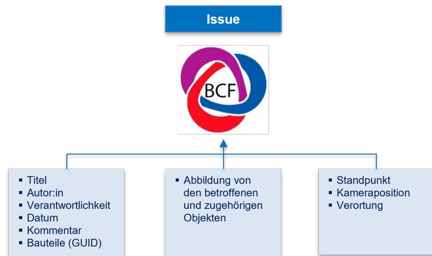
Abb. 7: Beispielhafte Inhalte BIM Collaboration Format (BCF) (©BIM.Hamburg, 2023)
