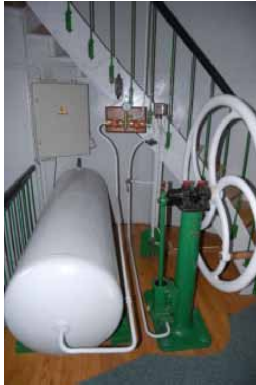
Ganz links: Quecksilbermotor und Druckminderer im Museumsleuchtturm Dicke Berta, Cuxhaven
