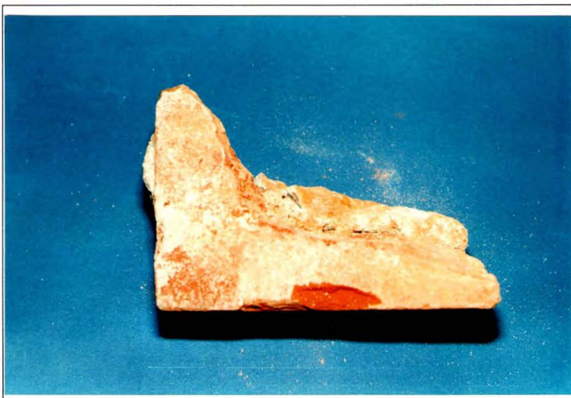
Bild 64: Im Ribbereich entnommener Stein des neuen Mauerwerks
