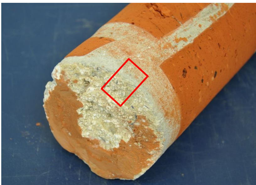
Abb. 12: Mörtelproben für die mikroskopische Untersuchung (Mö I/4, III/3, IV/3 und V/2)
