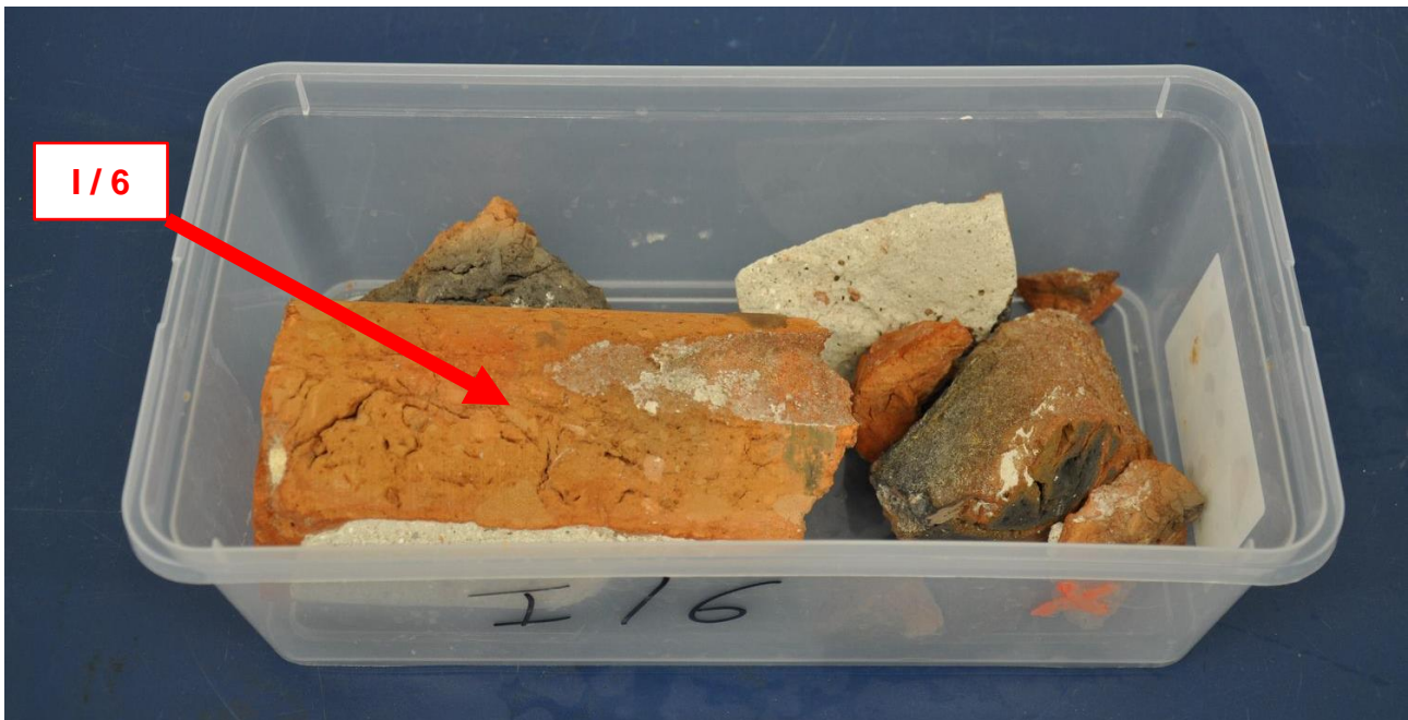
Abb. 5: Bohrkernsegment I/6 für Kennwertermittlung (bauzeitlicher Ziegel)
