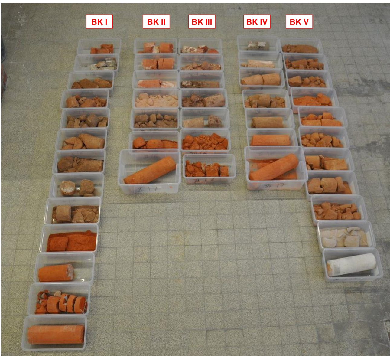
Abb. 1: Bohrkern BK I bis V im Entnahmestadium. Die Bohrkernstückchen sind stark mit Bohrmehl bedeckt. Erst nach dem Waschen sind die Bestandteile ausreichend gut erkennbar (vgl. Abb. 2 bis 4)
