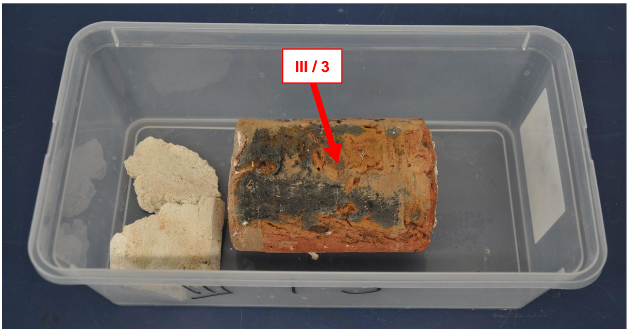
Abb. 7: Bohrkernsegment III/3 für Kennwertermittlung (bauzeitlicher Ziegel)
