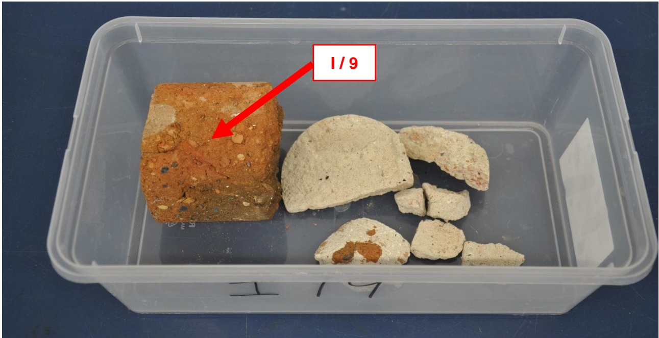
Abb. 6: Bohrkernsegment I/9 für Kennwertermittlung (bauzeitlicher Ziegel)
