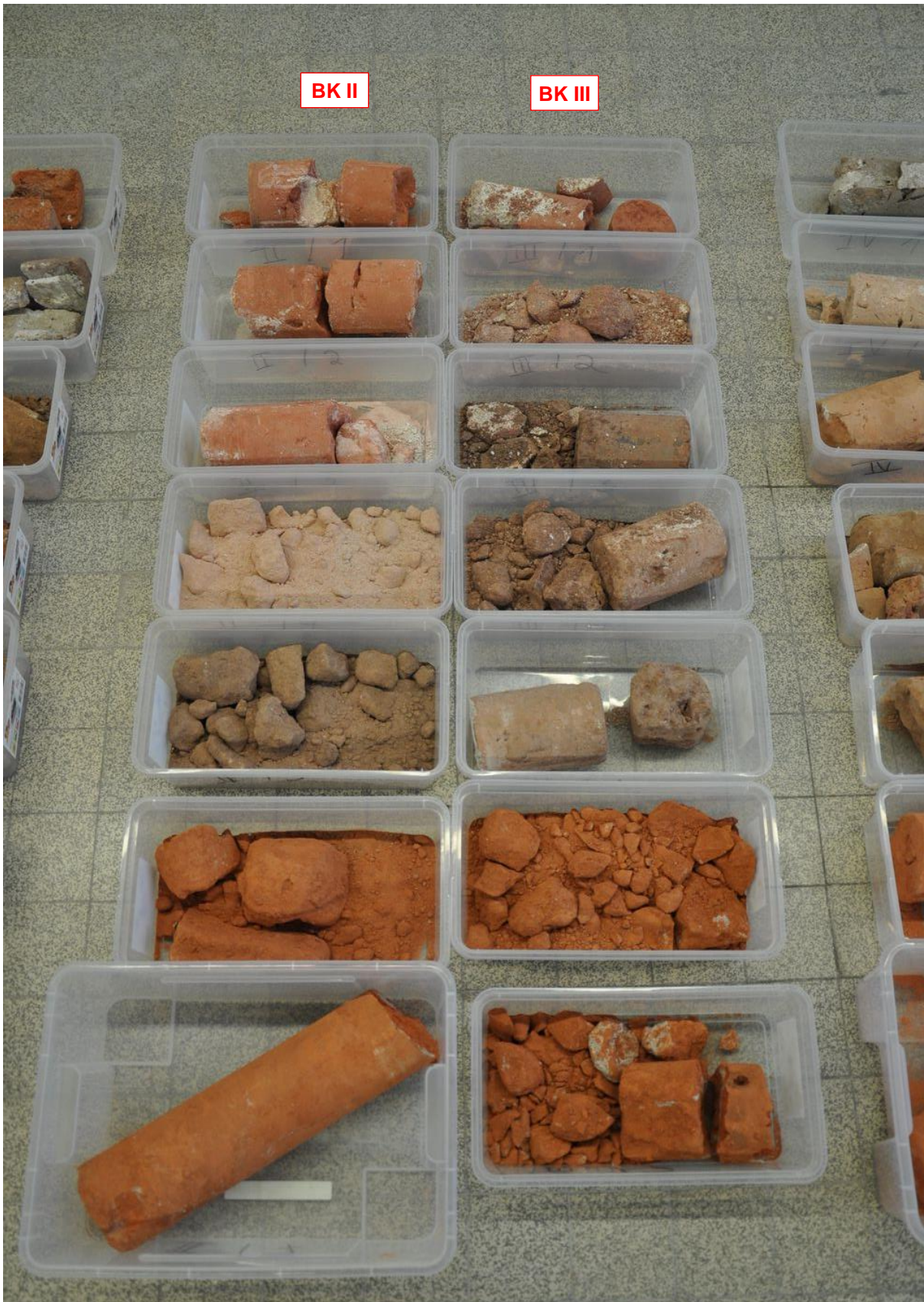
Abb. 3: Detail aus Abb. 1. Bohrkern BK II und III im Entnahmestadium. Die Bohrkernstückchen sind stark mit Bohrmehl bedeckt. Erst nach dem Waschen sind die Bestandteile ausreichend gut erkennbar (vgl. Abb. 4)
