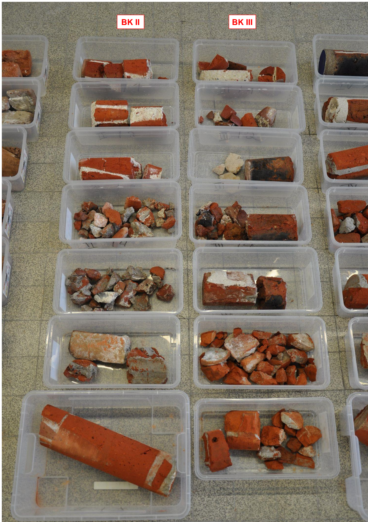
Abb. 4: Detail aus Abb. 2 Bohrkern BK II und III nach dem Waschen. Die Bestandteile (Ziegel- und Mörtelstücke) sind für die weitere Bearbeitung (Kennwertbestimmung, Mikroskopie) ausreichend gut erkennbar.
