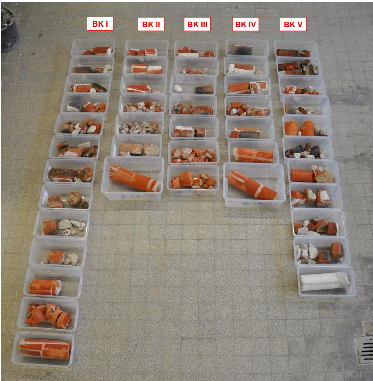
Abb. 2: Bohrkern BK I bis V nach dem Waschen. Die Bestandteile (Ziegel- und Mörtelstücke) sind für die weitere Bearbeitung (Kennwertbestimmung, Mikroskopie) ausreichend gut erkennbar (vgl. Details in Abb. 3 und 4 4)
