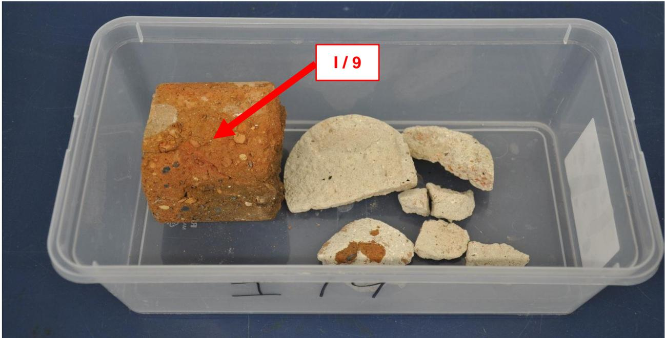
**Abb. 6:** Bohrkernsegment I/9 für Kennwertermittlung (bauzeitlicher Ziegel)
