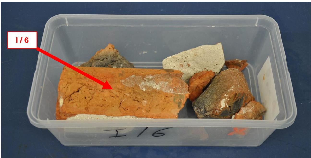
**Abb. 5:** Bohrkernsegment I/6 für Kennwertermittlung (bauzeitlicher Ziegel)
