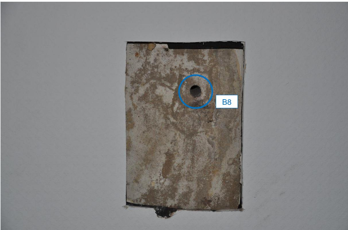
**Abb. 49:** Entnahmestelle der Bohrmehlprobe **B8** (Ebene 5, N-Seite)
