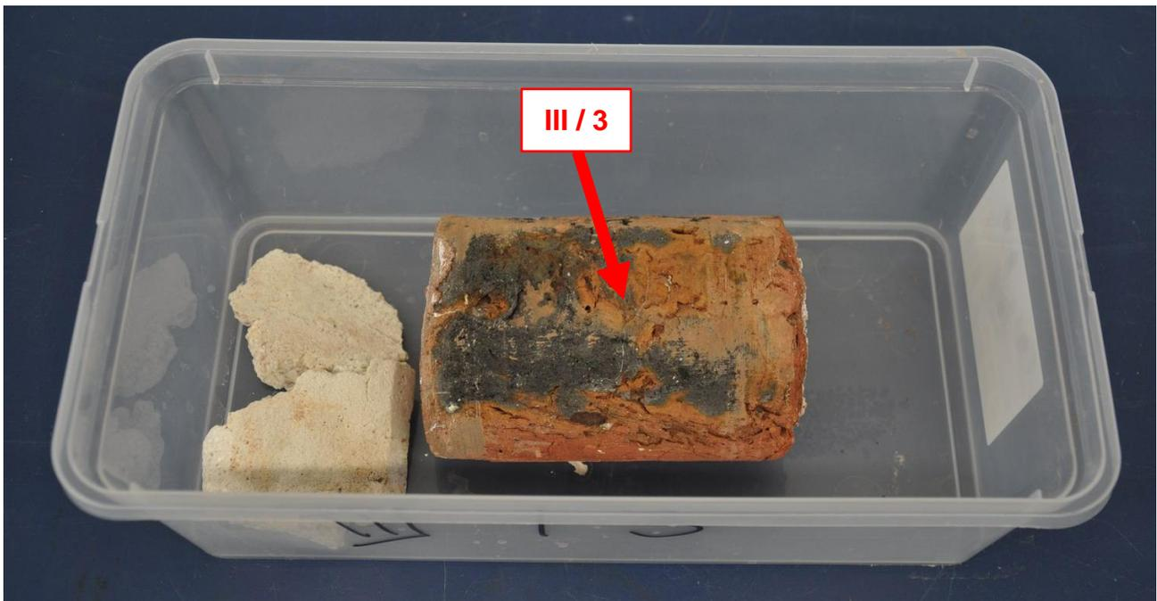
**Abb. 7:** Bohrkernsegment III/3 für Kennwertermittlung (bauzeitlicher Ziegel)
